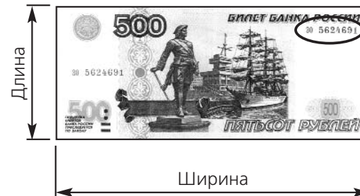
Область расположения магнитной метки на российских рублях
